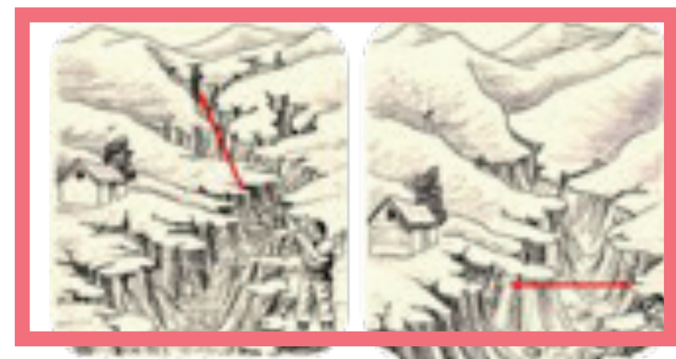
Figura 73. Crecimiento de cárcava hacia arriba (izquierda) y cárcava hacia el costado (derecha)
