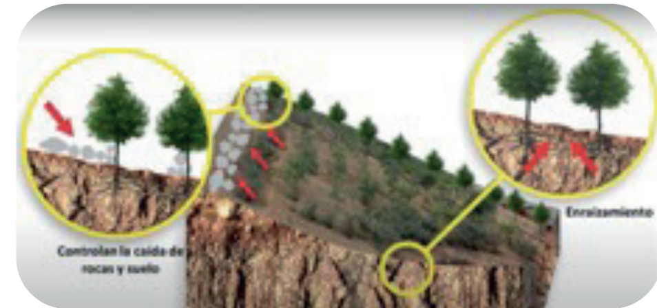
Figura 53. La reforestación ayuda a disminuir los deslizamientos y caída de rocas debido a su enraizamiento al suelo
