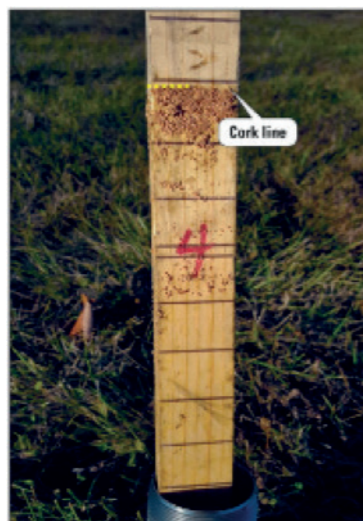
Figura 23. Marca de crecida máxima alcanzada mediante el uso de la estación de cresta
