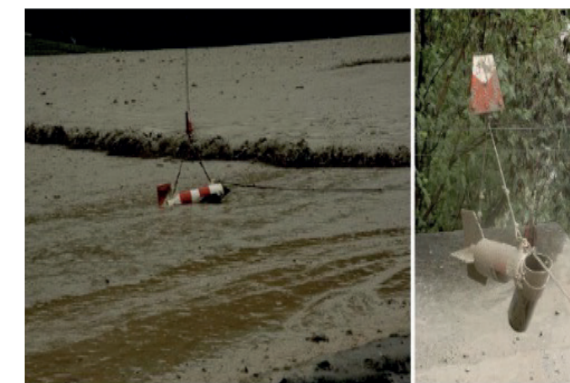
Figura 90. Ejemplos de mediciones de sedimentos y del flujo de escombros (Jiangia Gou, China). Parámetros extraídos son: densidad de la mezcla, concentración de sedimentos y parámetros reológicos
