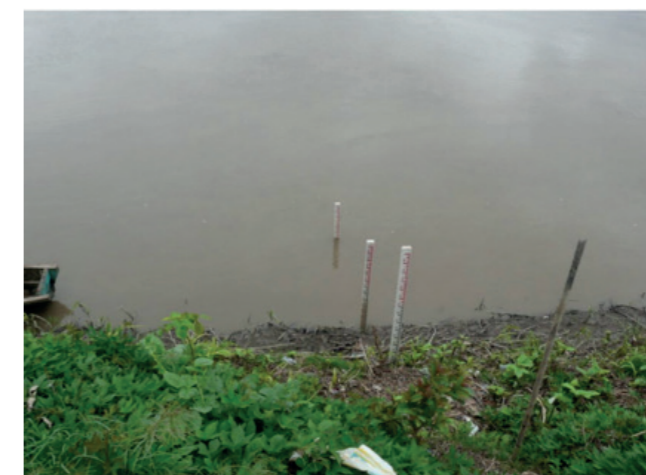
Figura 19. Reglas limnimétricas colocadas en una estación de medición de superficie de agua sobre la región de Pucallpa
