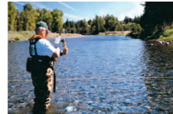
Figura 29. Medición mediante vadeo sobre la sección transversal de control
