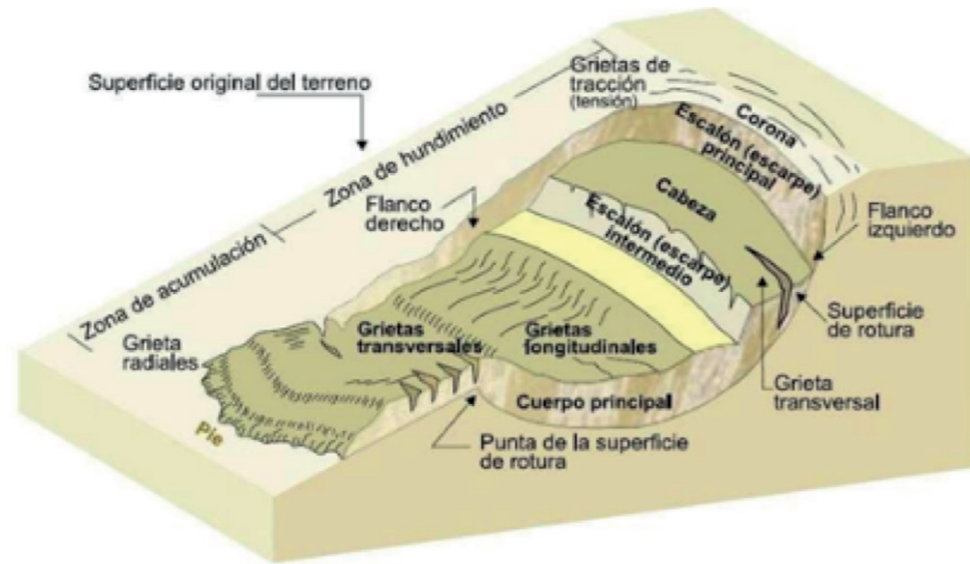
Figura 58. Componentes del deslizamiento
