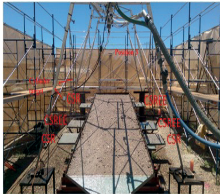
Figura 47. Simulador de precipitaciones, caja de sedimentos puntos fijos y estructuras de concreto (puntos de referencia fijos)
