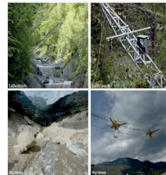
Figura 86. Ejemplos de mediciones de profundidad de flujos de escombros en Lattenbach (Austria) y Illgraben (Suiza)
