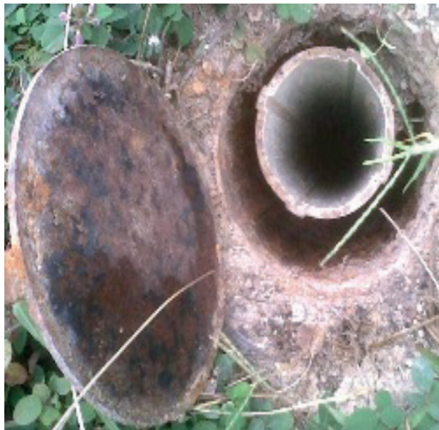
Figura 67. Tubo guía PVC para sonda inclinométrica
