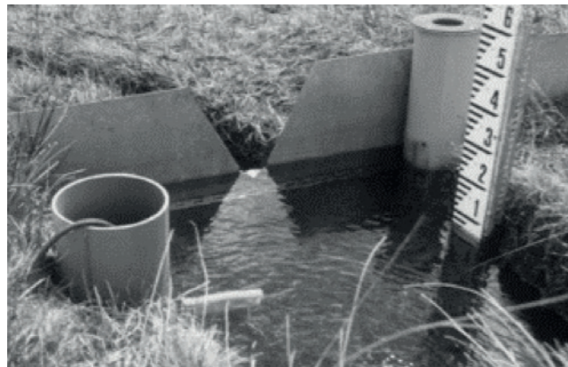
Figura 34. Vertedero triangular de pared delgada
