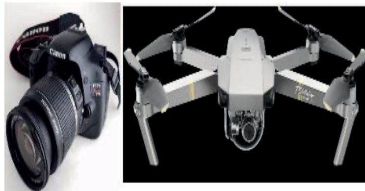
Figura 44. Equipos fotográficos y drone para el relevamiento en campo y caracterización topográfica
