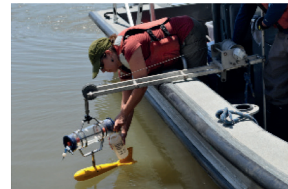
Figura 36. Captura de sedimentos en suspensión: muestreador de sedimentos en suspensión USGS
