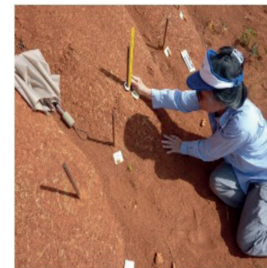
Figura 45. Demostración de la técnica de mediciones con altura de pines
